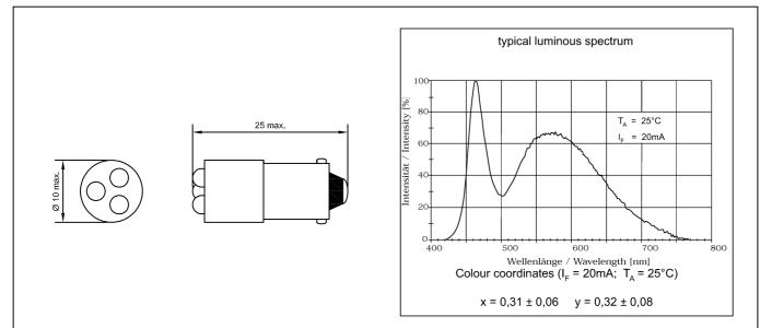
Lampensockel nach DIN EN 60061-1: BA9s / Lamp base in accordance to DIN EN 60061-1: BA9s
